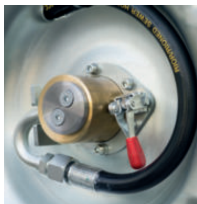
Standard mechanischer RioFree Freilauf für müheloses Abwickeln der Spule
