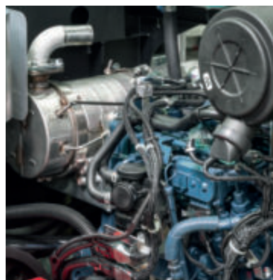
Tier 4/Stufe V Motor mit eingebautem Partikelfilter und Katalysator
