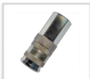
Druckluft-Kupplung NW 7,8 mm, 1/8" IG mit Sicherungsring Art.Nr.: 110173
