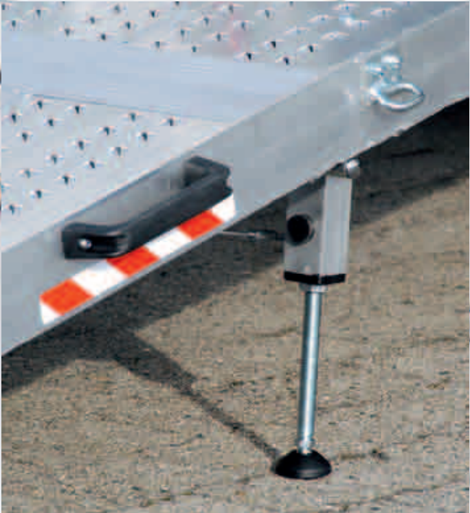
Optional: Mit zwangsgeführtem Stützfuß sind Tragkräfte bis 1000 kg möglich.
