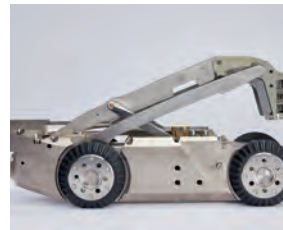
Elektrisches Hubgetriebe Stufenfreie Kamera- positionierung ab 150 mm
