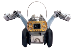
Fahrhilfe Eiprofil von 200/300 mm bis 900/1350 mm
